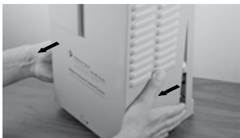
Figure 5 – Tirer sur la partie inférieure du couvercle
