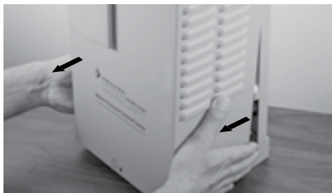
Figura 5 - Jale la parte inferior de la cubierta y sáquela.
