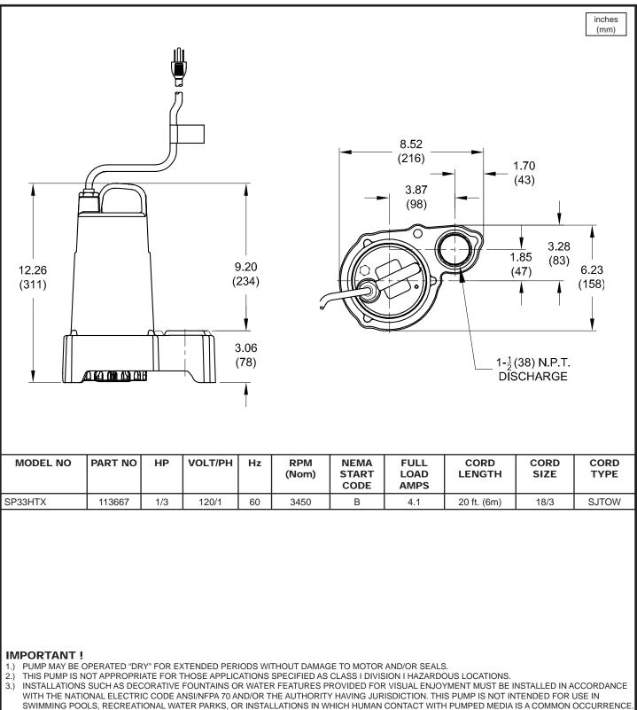
4.) MUST USE A HIGH TEMPERATURE WIDE ANGLE LEVEL CONTROL IN HIGH TEMPERATURE APPLICATIONS.
